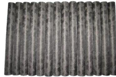
Abbildung 3: FilaWin<sup>®</sup> 50k Probekörper mit einem  $\pm 45^\circ$  Lagenaufbau
