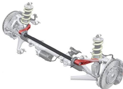
Abbildung 1: Fahrwerksstabilisator als fahrdynamisches Bauteil zur Beeinflussung von Wank- und Einlenkverhalten des Fahrzeuges (Quelle: Audi AG)
